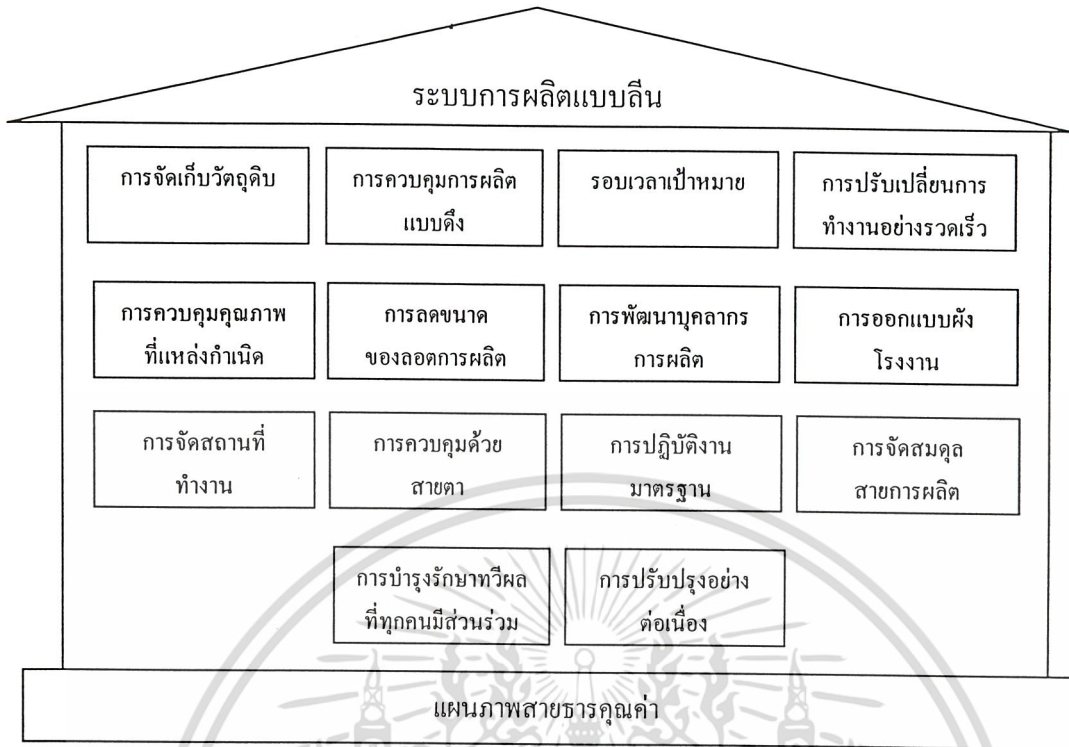
รูปที่ 2.7 แสดงเครื่องมือในระบบการผลิตแบบลีน
