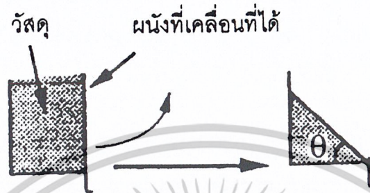
รูปที่ 2.14 การวัดมุมกองวัสดุ โดยให้วัสดุก่อตัวบนผนัง
