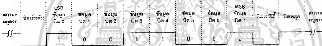
รูปที่ 2.5 รูปแบบของข้อมูลอนุกรมแบบอะซิงโครนัส
