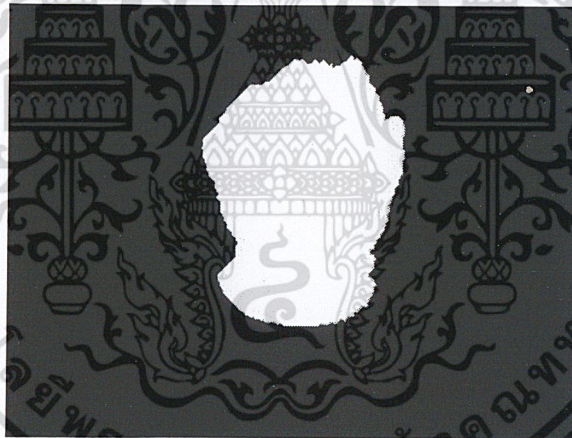
รูปที่ 6-6 ภาพที่ผ่านกระบวนการไดเลชัน (dilation)
