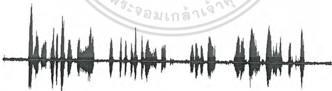
รูปที่ 6-3 แสดงลักษณะสัญญาณเสียงที่ผ่านการเข้ารหัสสัญญาณเสียง (rate 6.3 kbit/s) ตามมาตรฐาน G.723.1
