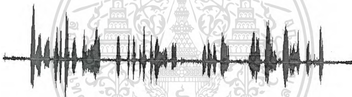
รูปที่ 6-2 แสดงลักษณะสัญญาณเสียงที่ผ่านการเข้ารหัสสัญญาณเสียง (rate 5.3 kbit/s) ตามมาตรฐาน G.723.1
