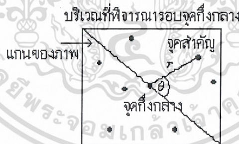
รูปที่ 5.11 แสดงระยะห่างระหว่างจุดกึ่งกลางกับจุดที่มีลักษณะสำคัญ และมุมที่ทำกับแกนของภาพภายในบริเวณรอบจุดกึ่งกลาง
