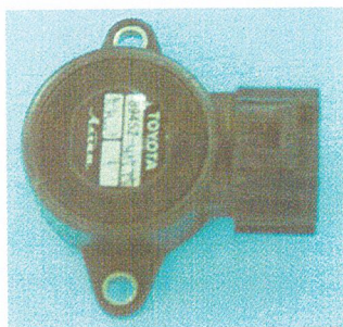
รูปที่ 4.17 ตัวตรวจจับตำแหน่งลิ้นเร่งและส่วนประกอบของตัวตรวจจับตำแหน่งลิ้นเร่งแบบเชิงเส้น
