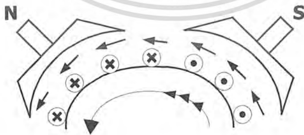
รูปที่ 2.8 หลักการของมอเตอร์
