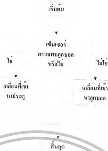
รูปที่ 4.5 โฟลว์ชาร์ตแสดงการประมวลผลของส่วนปัญญาประดิษฐ์
