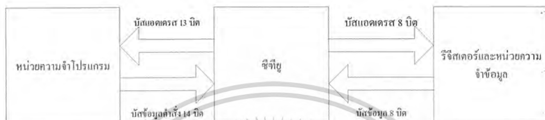
รูปที่ 3.1 แสดงแบบสถาปัตยกรรมของไมโครคอนโทรลเลอร์แบบฮาร์ดแวร์
