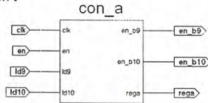
รูปที่ 4.71 แสดงสัญลักษณ์ของวงจรควบคุมการแปลงดิสครีตโคซายน์
