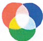
รูปที่ 7.2 แสดงสีภายใน 1 Pixel
