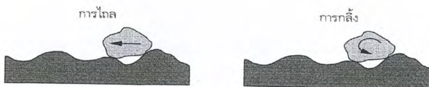
รูปที่ 2.10 แสดงลักษณะการเคลื่อนที่สัมผัสแบบการไถลและการกลิ้ง
