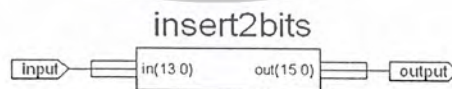
รูปที่ 4.48 แสดงสัญลักษณ์ของวงจรแทรกบิท 2 บิต
