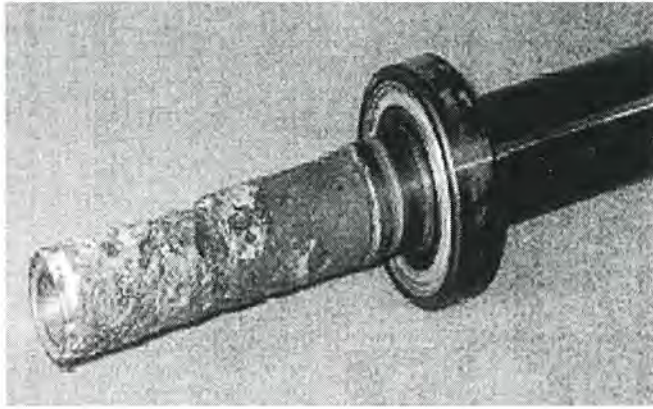
รูปที่ 2.6 ความเสียหายของเพลลา
