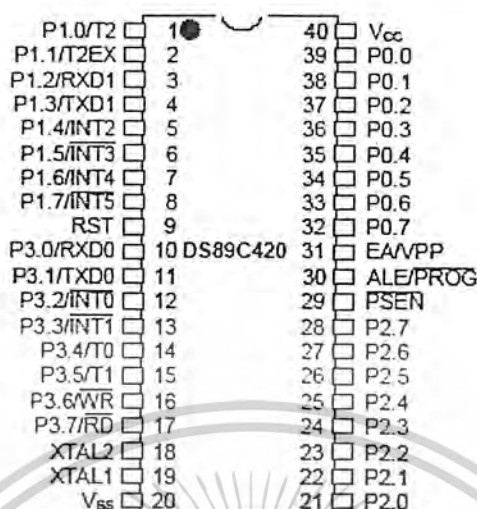
รูปที่ 5.2 แสดงรูปร่างและการจัดวางขาต่างๆ ของไมโครคอนโทรลเลอร์ MCS-51
