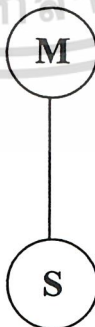
รูปที่ 2.2 การเชื่อมต่อแบบพอยนท์-ทู-พอยนท์ (point-to-point)
