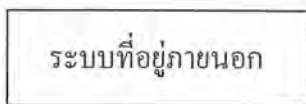
รูปที่ 2.13 สัญลักษณ์แทนสิ่งที่อยู่นอกระบบเป็นรูปสี่เหลี่ยมผืนผ้า
