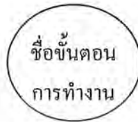
รูปที่ 2.6 สัญลักษณ์แทนขั้นตอนการทำงานเป็นวงกลม
