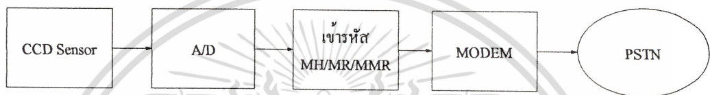
รูปที่ 2.1 หลักการทำงานของโทรสารด้านส่ง
