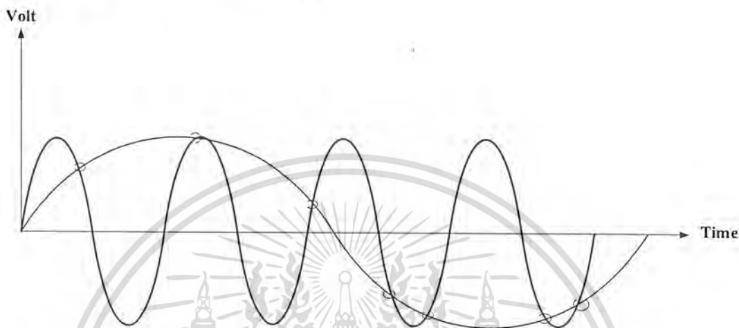
รูปที่ 2.11 การเกิดความถี่ Aliasing
