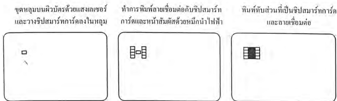
รูปที่ 2.3 การสร้างสมาร์ทการ์ดโดยวิธีการสร้างหน้าสัมผัสบนผิวของบัตร
