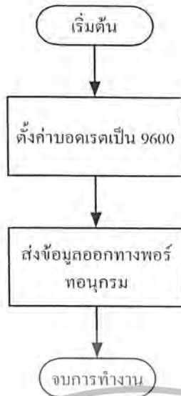
รูปที่ 3.5 แผนผังการทำงานของ การสื่อสารข้อมูลผ่านพอร์ทอนุกรม RS232
