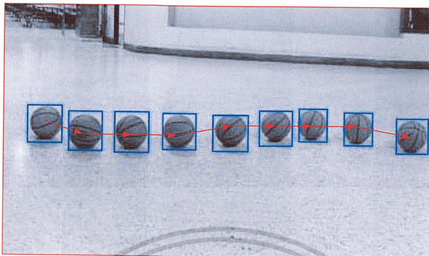
รูปที่ 6.12 รูปแสดงทิศทางการติดตามลูกบอลที่มีการเคลื่อนที่อย่างต่อเนื่อง
