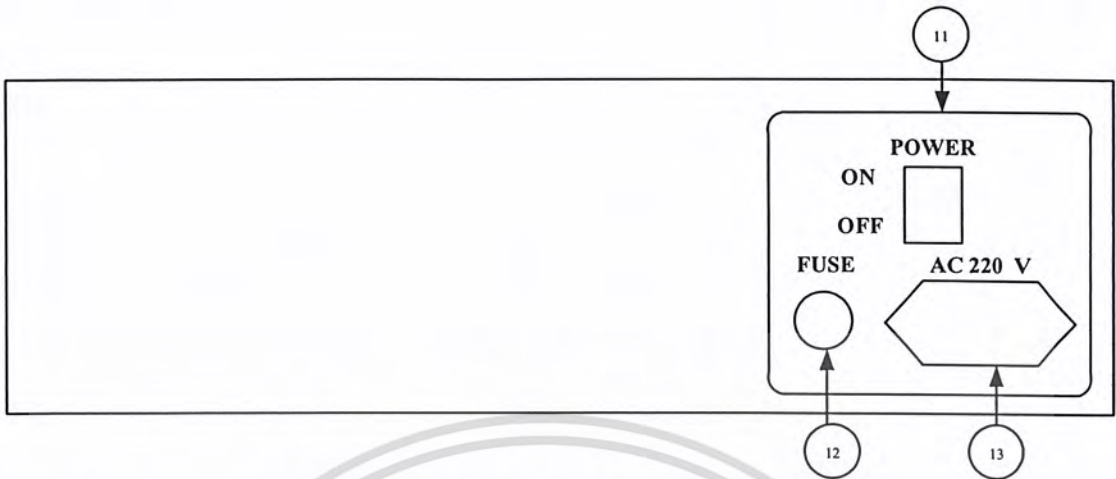
รูปที่ ข.2 ส่วนประกอบ และปุ่มควบคุมของชุดทดลองวงจรดิจิทัลควบคุม และแสดงผลโดยใช้คอมพิวเตอร์ด้านหลัง
