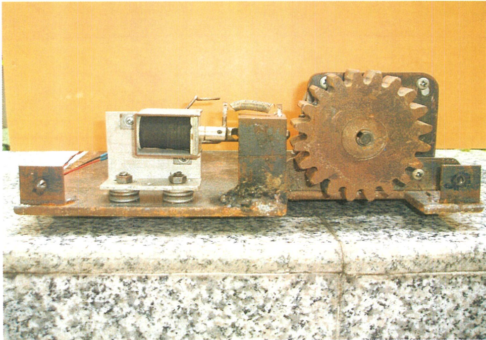
รูปที่ 4.4 สถานะที่หยุดจ่ายแรงดันให้กับโซลินอยด์ มีค่าเท่ากับ 0 โวลต์
