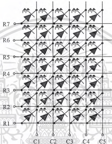
รูปที่ 2.6 วงจรภายในของแอลอีดีดอตแมทริกซ์
