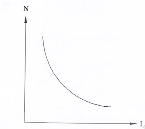
รูปที่ 2.10 แสดงความสัมพันธ์ระหว่างความเร็วรอบกับกระแสในอาร์เมเจอร์
