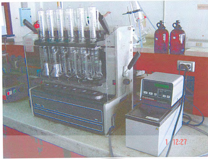
รูปที่ 1 เครื่องสกัดไขมัน ( Soxtherm apparatus) ของ BUCHI 810
