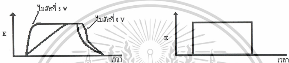
รูปที่ 2.32 การเปรียบเทียบพัลส์อินพุตและพัลส์เอาต์พุตเป็นผลเนื่องมาจาก Diffusion Time
