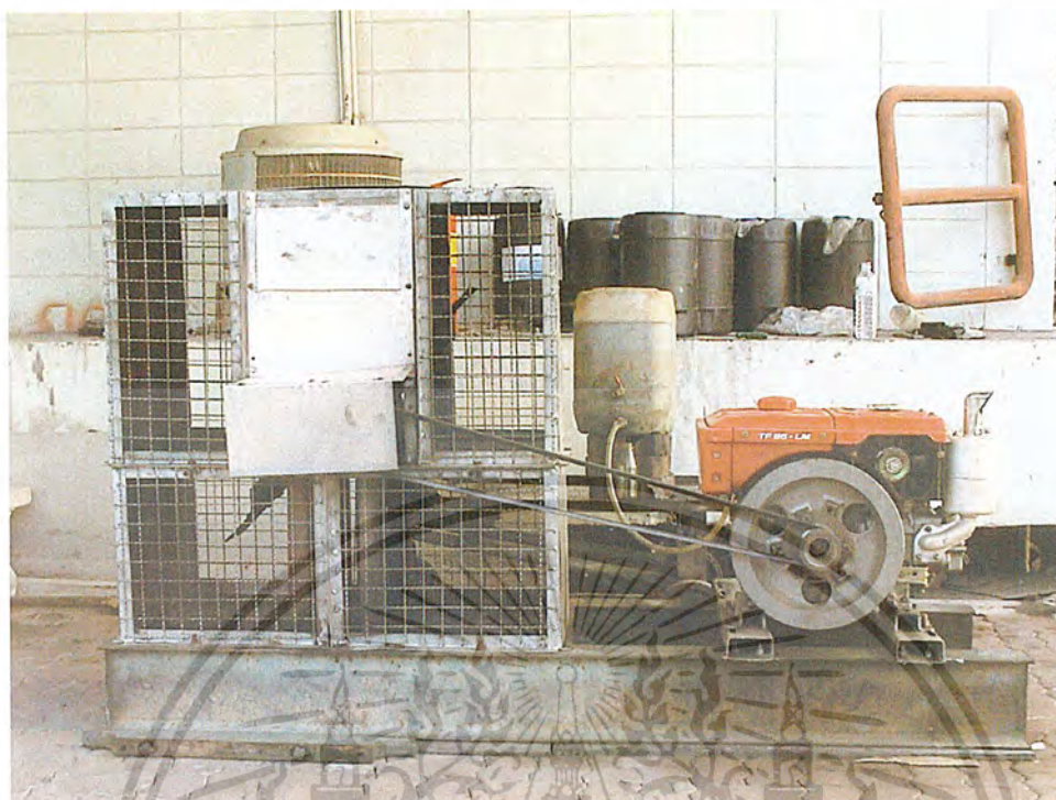
รูปที่ 3.6 แสดงเครื่องยนต์และแท่นที่ใช้ทดสอบการสึกหรอ
