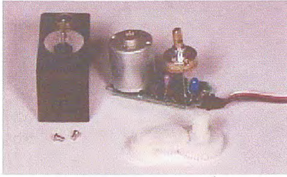
รูปที่ 2.11 Servo motor ที่ถอดชิ้นส่วนแล้ว
