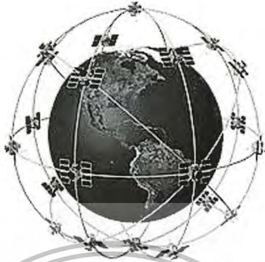
รูปที่ 2.16 แสดงกลุ่มดาวเทียมจีพีเอส โดยมีระนาบวงโคจร 6 ระนาบ
