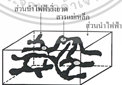
รูปที่ 4.1 แบบจำลองโครงสร้างมหภาคของตัวนำไฟฟ้ายิ่งยวดชนิด Gd-Ba-Cu-O
