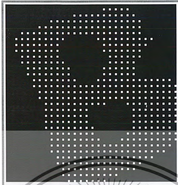
รูปที่ 3.16 ภาพแสดงการทำ Filter ในกรณีที่จุดข้างเคียงเป็น 1 มากกว่า 3 จุด
