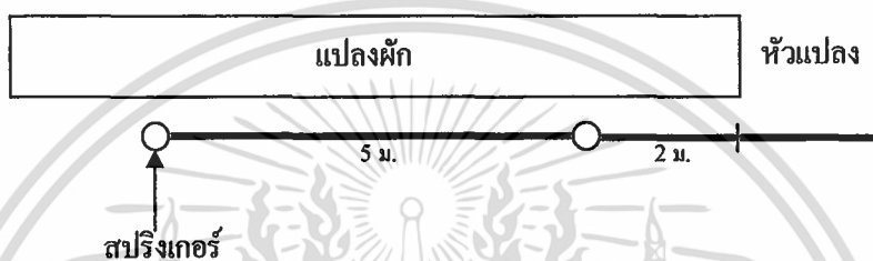
ภาพที่ 16 แสดงระยะห่างระหว่างสปริงเกอร์ในแต่ละแถว
