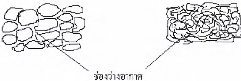
รูปที่ 3.4 แสดงถึงขนาดของช่องอากาศที่เกิดขึ้นกับวัสดุผง
