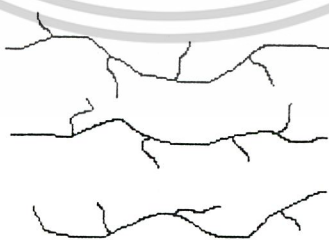
รูปที่ 2.3 ตัวอย่างรูปแบบการจัดเรียงตัวของเทอร์โมพลาสติก [4]
