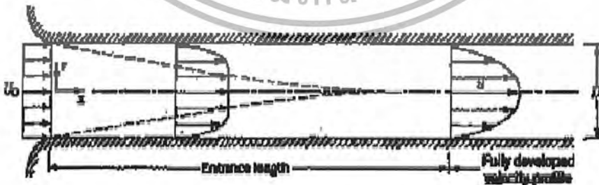
รูปที่ 4.1 แสดงการพัฒนากระบวนการไหลในท่อ
