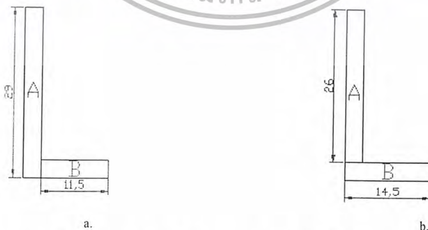
รูปที่ 3 – 2 การแบ่งส่วนของใบกวนแบบ Anchor เพื่อนำไปใช้คำนวณ
