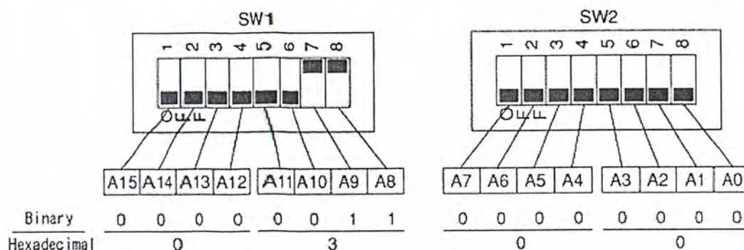
รูปที่ 3-18 การติดตั้งคิปสวิตช์เพื่อกำหนดแอดเดรส
