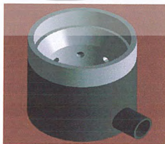
รูปที่ 3.4 ภาพสามมิติของหัวเผาแบบที่ 1
