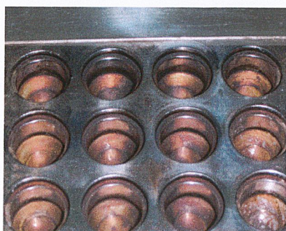
รูปที่ 4.42 แม่แบบที่สุกปรก รอการทำความสะอาด
