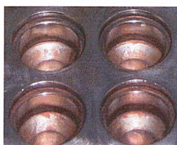
แม่แบบที่ไม่ได้ผ่าน การทำความสะอาด
