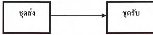
ภาพที่ 3.3 แสดงการสื่อสารข้อมูลอนุกรมแบบ Simplex
