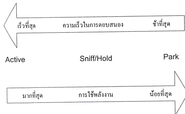
รูปที่ 2.4 ความสัมพันธ์ระหว่างความเร็วในการตอบสนอง และการใช้พลังงาน ในโหมดการทำงานทั้ง 4 โหมด
