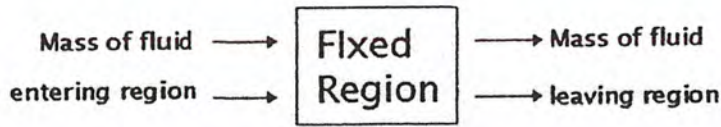
รูปที่ 2.2 แสดงมวลของไหลไหลเข้าขอบเขตที่กำหนด
