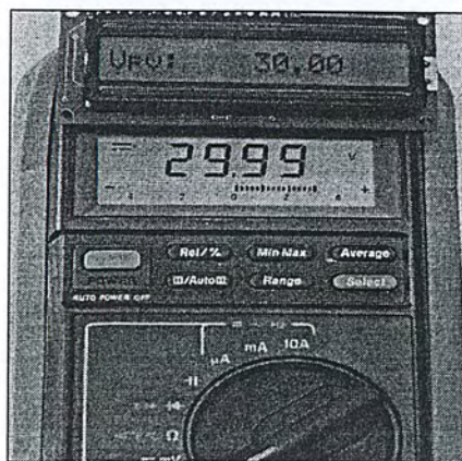
รูปที่ 4.28 แสดงการเปรียบเทียบ การแสดงค่าแรงดันทางจอ LCD กับค่าจริงที่วัดจากมิเตอร์
