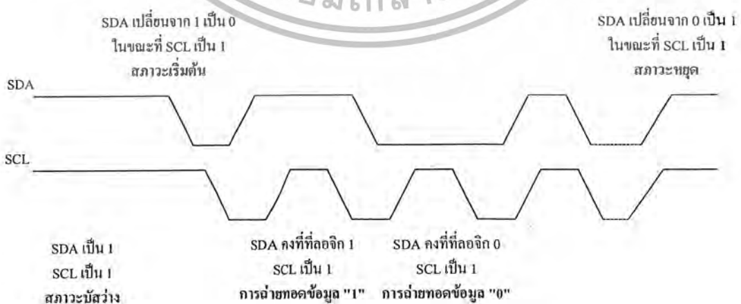
รูปที่ 2.16 ไคอะแกรมเวลาแสดงสถานะต่างๆในบัส I 2 C
