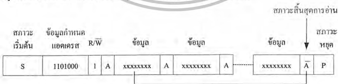
ข้อมูลที่ออกจาก DS1307 พร้อมสัญญาณตอบรับ
