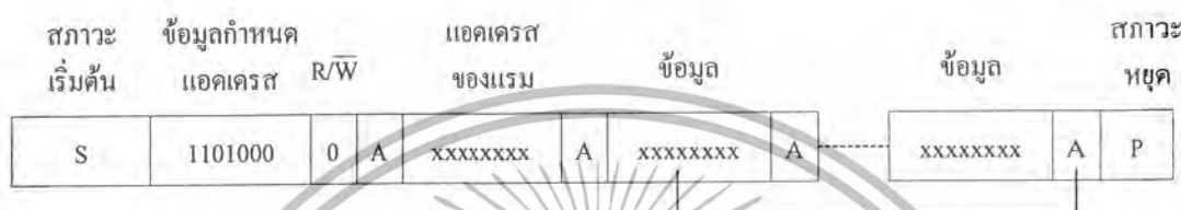
ข้อมูลที่เขียนไปยัง DS1307 พร้อมสัญญาณตอบรับ
