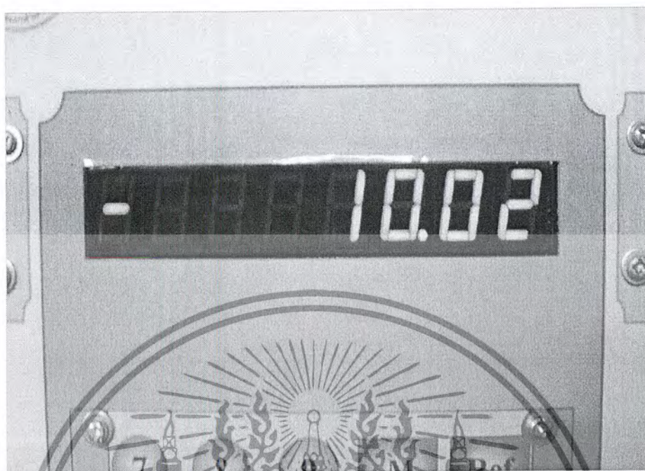
รูปที่ 4.7 ค่าที่แสดงผลเมื่อป้อนค่าตำแหน่งในขณะไม่มีการเชื่อมต่ออุปกรณ์อื่นๆ
