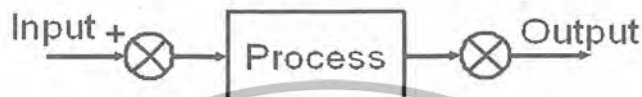
รูปที่ 3.1 แสดงตัวอย่างของระบบควบคุมแบบเปิด
