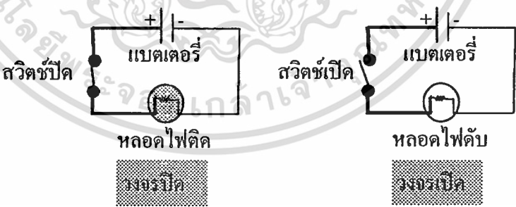
รูปที่ 2.1 การต่อวงจรไฟฟ้า
