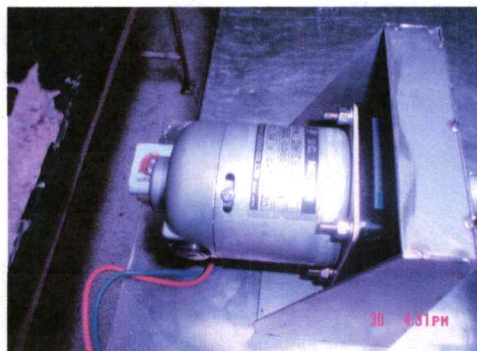
ภาพที่ 4.1 แสดงระบบมอเตอร์ DC. กระแสตรง
